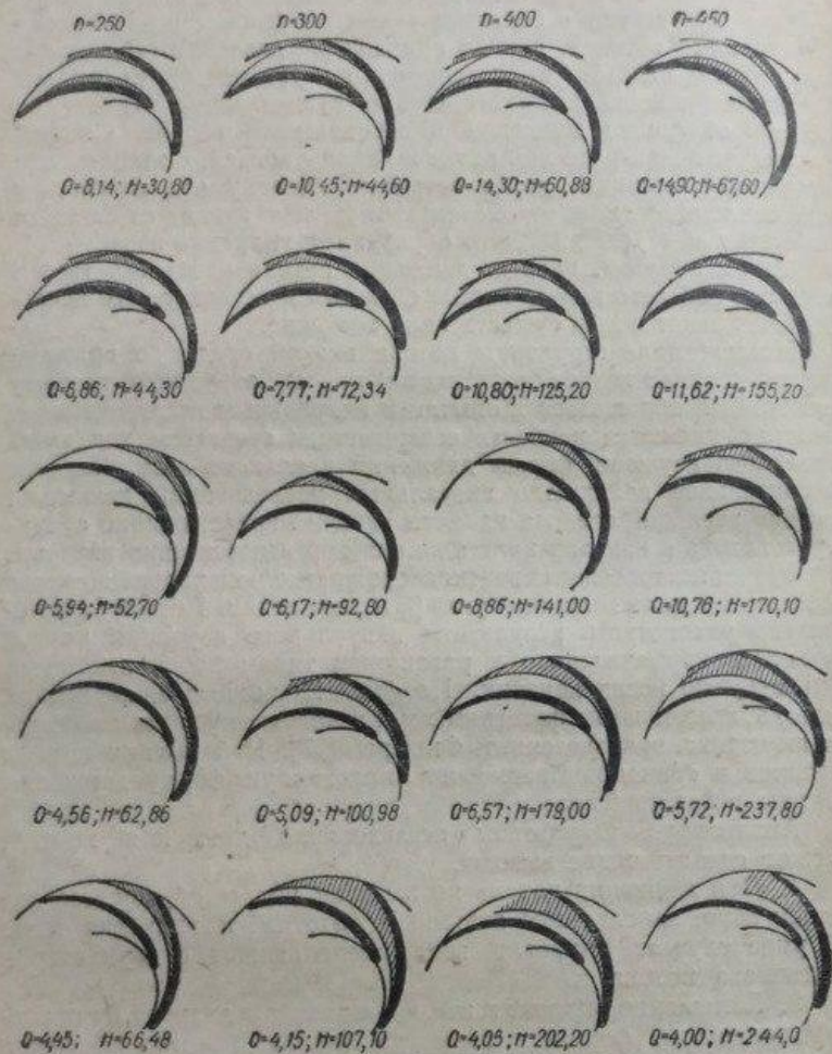
n - число оборотов в мин., Q - расход в литрах, H - напор в см. Фиг. 25. Зарисовки потока в каналах колеса при \beta_2 < 90^\circ .
