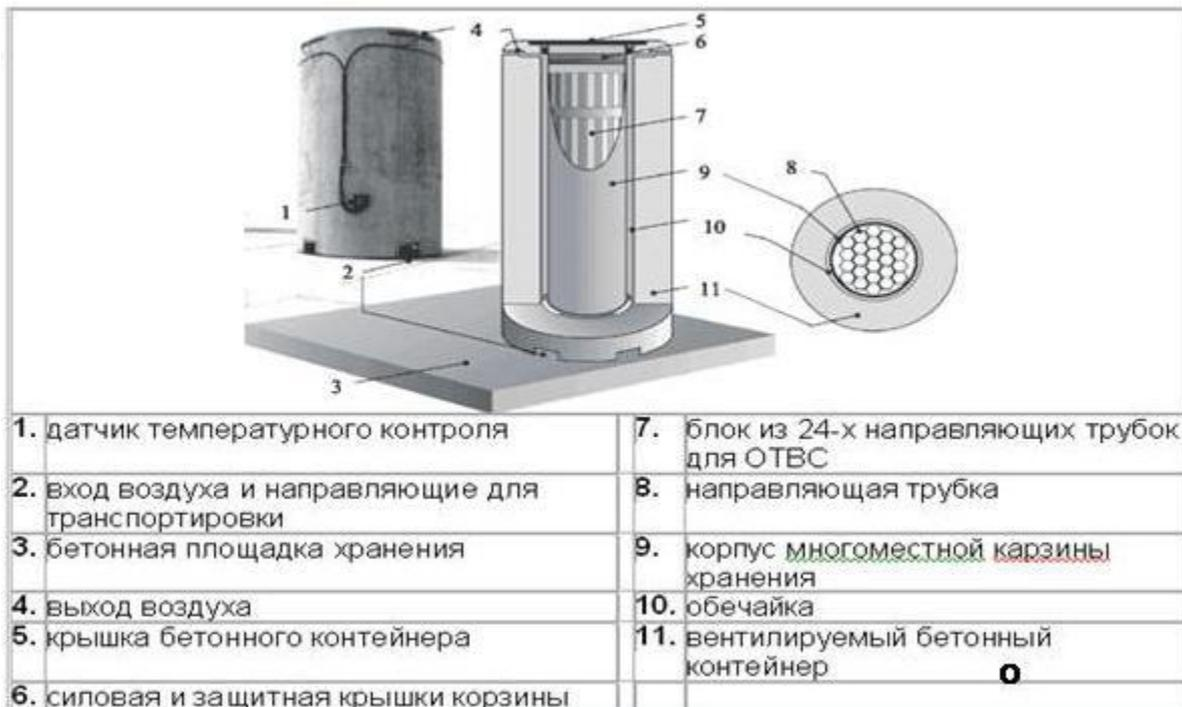
Рис.14.10. Контейнеры для хранения отработавшего ядерного топлива.
